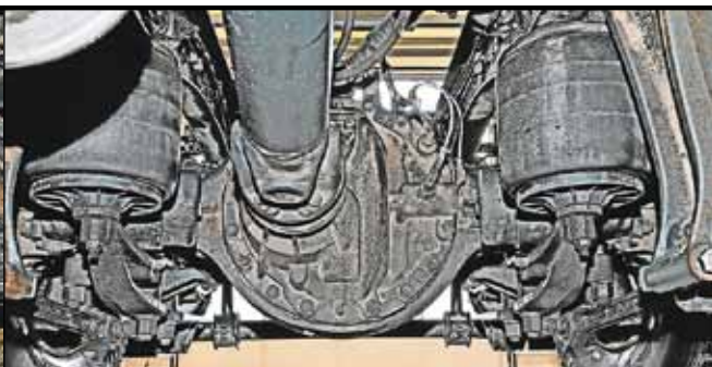
На скользкой дороге межколесный дифференциал можно заблокировать с помощью пневмопривода
