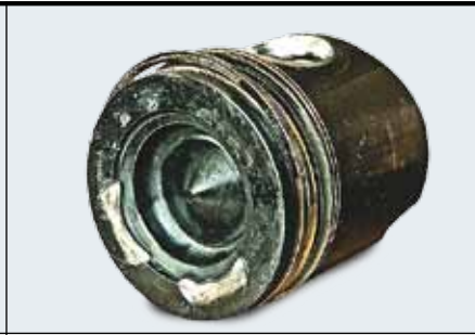
У мотора, пущенного вразнос, клапаны впечатываются в поршни
