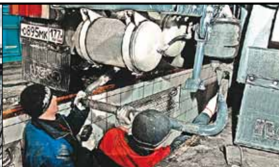
...но сайлентблоки и подушки стабилизатора – детали «расходные», и требуют замены чаще
