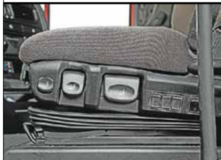
Сиденье оснащено пневмоподвеской и имеет множество регулировок
