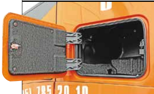
Снаружи кабины предусмотрен запираемый инструментальный ящик
