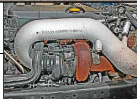
«Изменяемая геометрия» снижает долговечность турбокомпрессора
