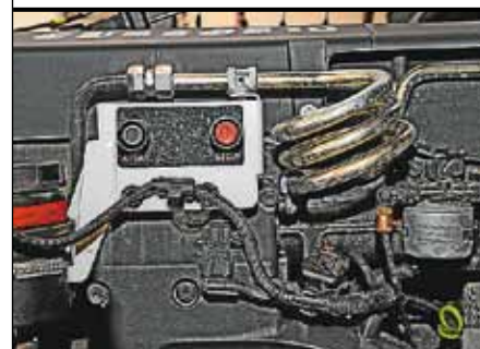
Пустить и заглушить мотор можно кнопками – не опуская кабину
