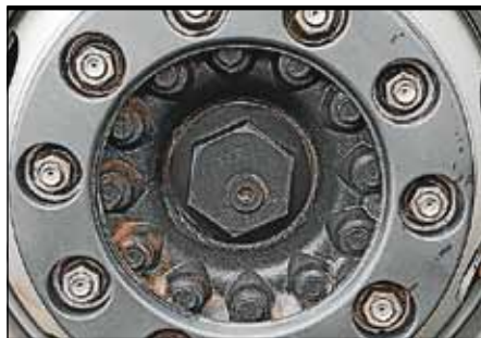
В передние ступицы заливают жидкое трансмиссионное масло
