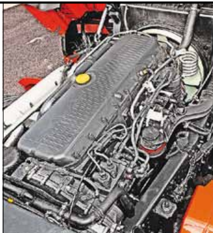
С 2013 года на Stralis ставят мотор Евро-6 с рампой Common Rail...
