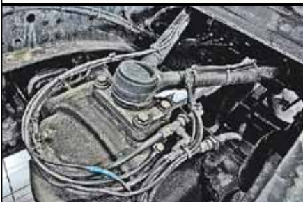
До 2007 года на V-образной тяге применяли шаровой шарнир...
