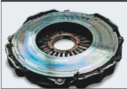
Даже самое добротное сделанное сцепление можно сжечь за один рейс
