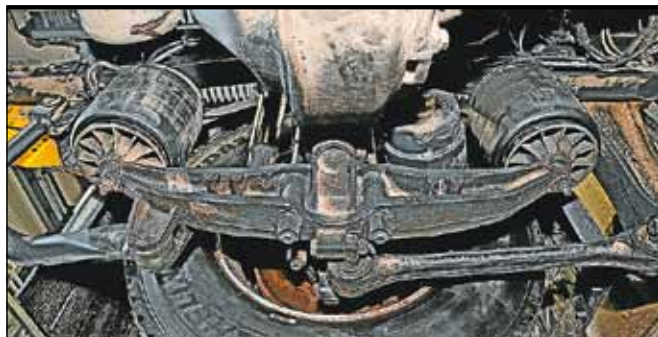
Подавляющее большинство тягачей IVECO Stralis оборудовано пневматической подвеской ведущего моста
