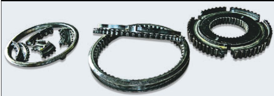
Синхронизаторы коробки передач обычно страдают на машинах у неопытных либо безответственных водителей. Ремонт влетает «в копейчку»
