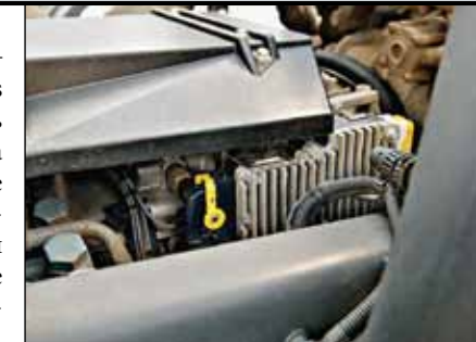
Блок ЗБУ закреплен не на двигателе, а на коробке передач справа
