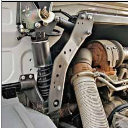
Сзади кабина подвешена на пружинно-гидравлических стойках
