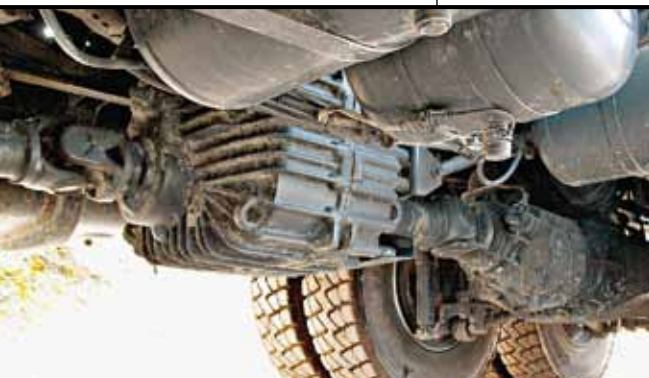
В трансмиссию полноприводных самосвалов 6x6 и 8x8 входит раздаточная коробка с оребрением картера
