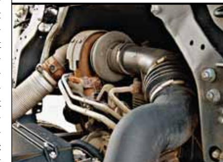
Турбокомпрессор всего один и расположен между блоками цилиндров
