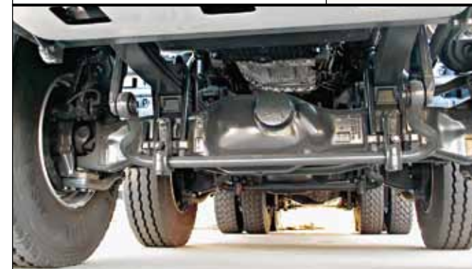
Благодаря компактному картеру главной передачи у полноприводного шасси Actros внушительный клиренс...
