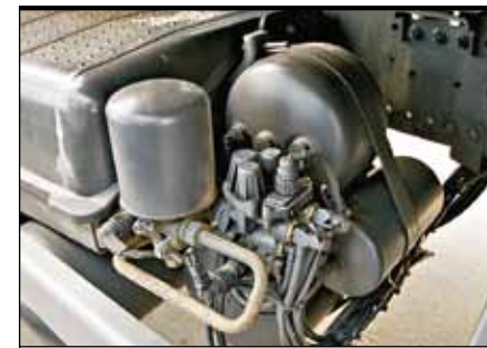
Модуль подготовки воздуха поставляет немецкая фирма Knorr-Bremse
