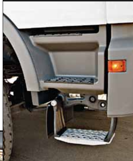
Мягкая подвеска нижней ступеньки необходима при выездах на грунт
