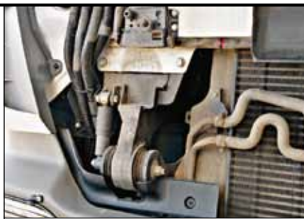
В передних точках подвески кабины сайлентблоки и амортизаторы
