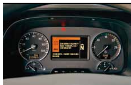
Ряд простейших неисправностей отображается на щитке приборов
