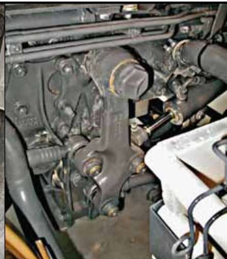
На шасси 8x4 в рулевом приводе второй оси есть гидроцилиндр
