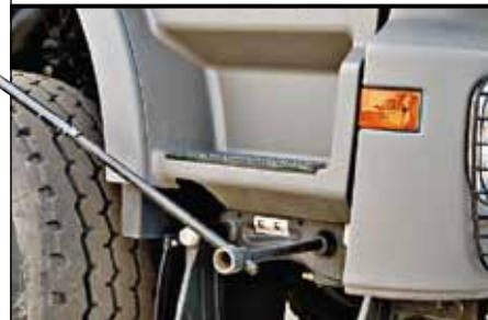
Насос гидроподъемника кабины расположен под второй ступенькой
