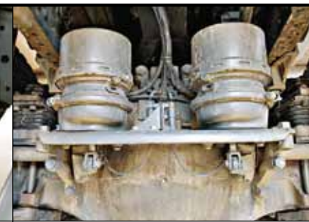
Пневмокамеры тормозов расположены высоко – такие не оторвешь
