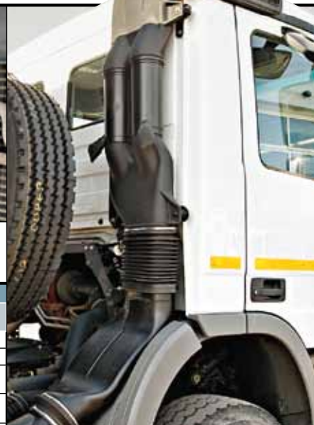
Низкорасположенный воздушный фильтр для самосвала не оптимален
