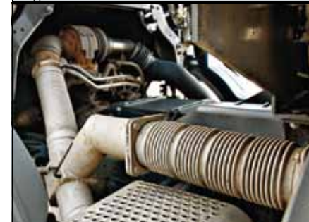
Для подогрева кузова можно перенаправить поток выхлопных газов
