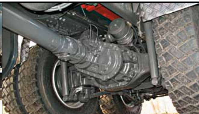
Передний мост балансирной тележки – проходной. Балки всех ведущих мостов – типа «банджо» литой конструкции
