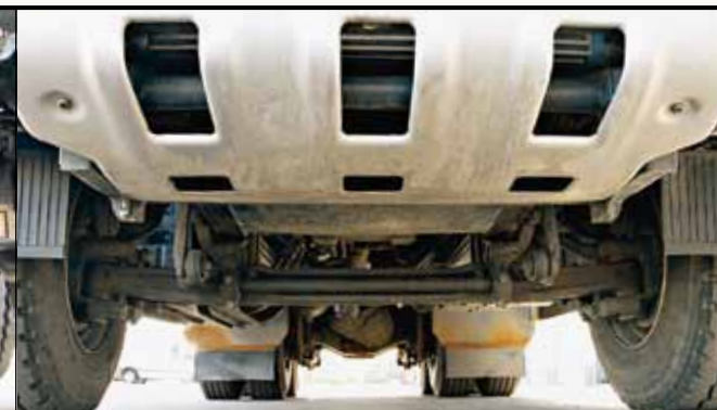
...а на обычных версиях с шасси 6x4 и 8x4 хорошую геометрическую проходимость дает спрямленная балка
