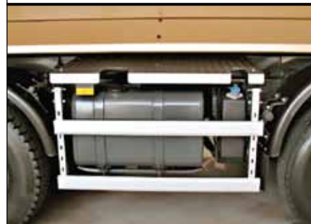
В современном исполнении самосвалы Actros – с баком для AdBlue
