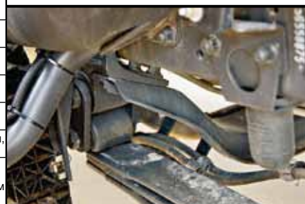
В шарнирах рессор применены необслуживаемые сайлентблоки
