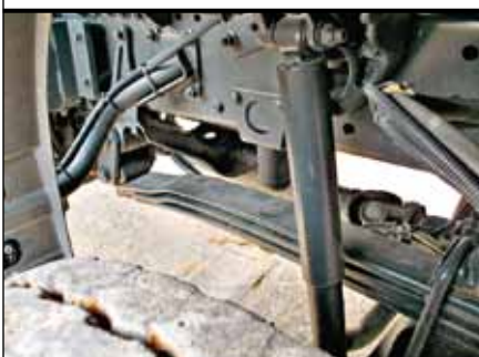
В передней подвеске – малолистовые параболические рессоры
