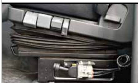
Рукоятка пневмопривода КОМ удобно расположена справа от сиденья
