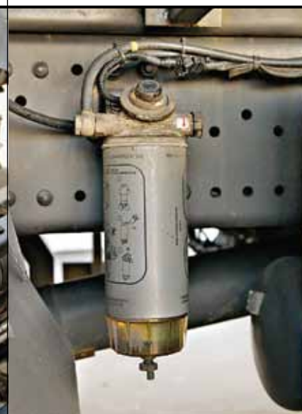
Водяной конденсат из сепаратора надо периодически сливать
