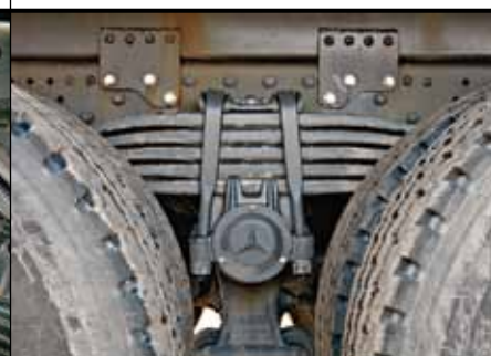
Пятилистовые рессоры балансирной подвески легко переносят перегрузы
