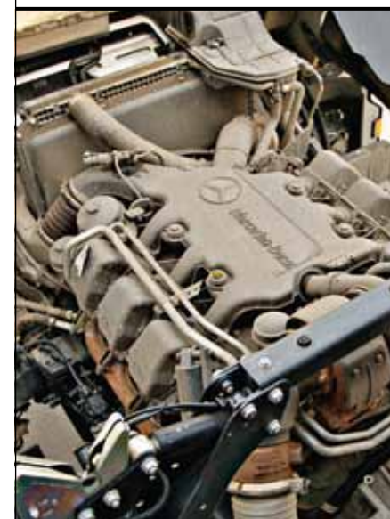
V-образный двигатель – особенность семейства Actros прежних поколений
