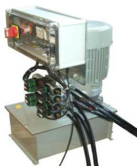
Гидростанция и щит управления
