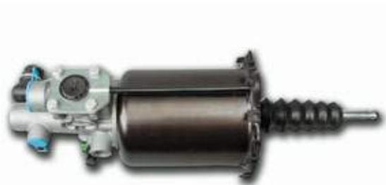
Bild 1: Kupplungsverstärker mit längerem Stößel
