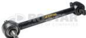
Штанга реактивная L=615 x 152 x d21
