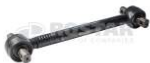
Штанга реактивная (Сайлентблок) L=566 x 130 x d19
