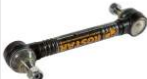
Тяга стабилизатора L=350 M22x1,5
