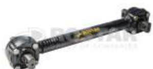
Штанга реактивная L=542 x 130 x d25
