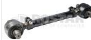
Штанга реактивная регулируемая L=571±14 x 130 x d21
