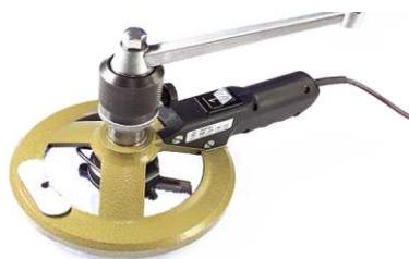
Служит для восстановления посадочных мест под гильзы блока цилиндров дизельных двигателей грузовых автомобилей. Машинка гарантирует качественную установку гильзы в блок цилиндров без его демонтажа с шасси
