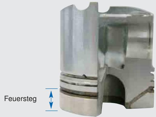
Abb. 4: Einteiliger Motorkolben
