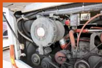
В заднем свесе GoldenDragon установлен двигатель Cummins ISLe4
