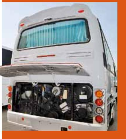
неприхотливый и выносливый дизельный двигатель Doosan (Евро-4) мощностью 400 л. с. и крутящим моментом 1697 Н.м. Межсервисный пробег корейского дизеля 60 тыс. км, как у 6-ступенчатой механической коробки передач Dymos.
