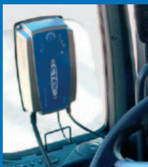
Um der Sulfatierung zu begegnen, ist hierbei dem eigentlichen Ladevorgang der Pulsmodus vorangestellt. Dieser schaltet bei allen CTEK Ladegeräten automatisch ein, wenn der innere Widerstand der Batterie auf eine fortgeschrittene Sulfatierung hinweist. Ein weiteres Problem ist die sogenannte Schichtung von Batterien, hierbei handelt es sich um eine Veränderung des
