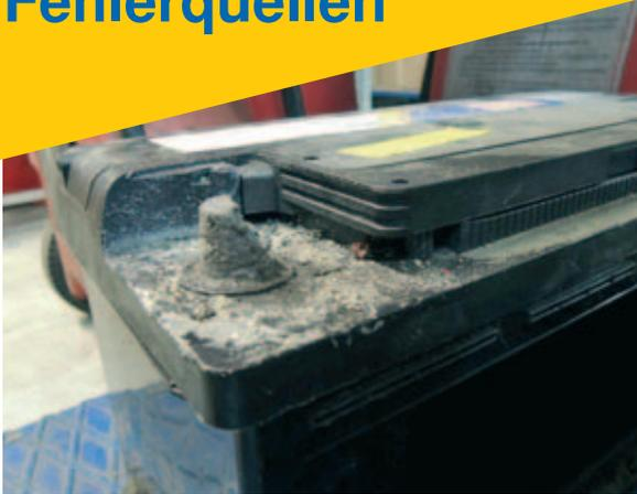
Starke Beschädigung: Batteriegehäuse und Gitter. Mögliche Ursache: Überladung oder verkehrter Lademodus.
