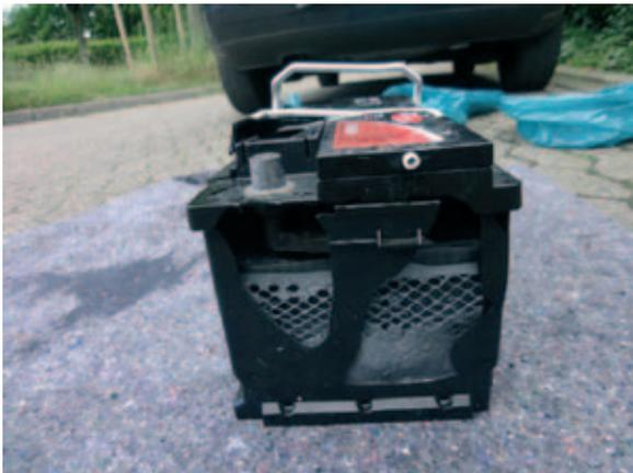
Batterie mit Polschaden. Deutlich sichtbare Ablagerungen!
