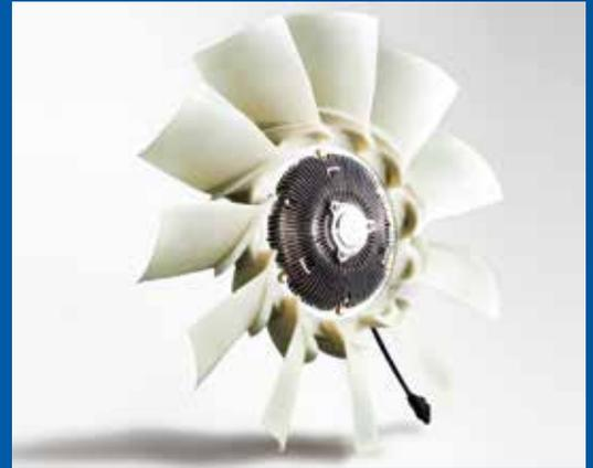
Zur Wärmeabfuhr bei NFZ-Motoren benötigt man neben leistungsfähigen Kühlern auch Lüfter und Lüfterantriebe, die Kühlluft besonders effizient bereitstellen. Viscolüfter bestehen aus einem Lüfterrad und einer Viscokupplung. Sie kommen bei längs eingebauten Motoren zum Einsatz und werden in Fahrtrichtung vor dem Kühler verbaut.
