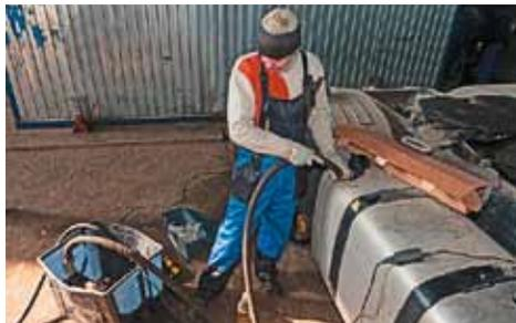
**Для изменения уровня топлива в баке применили насос с точным счетчиком**
