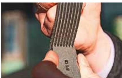
Прикладываем шаблон и оцениваем износ поверхности визуально
