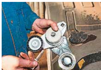
Два ролика при установке потребовали предварительной подсорбки
