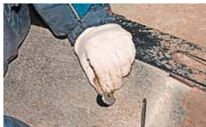
При сверлении коронкой важно было не упустить «шайбу» в бак
