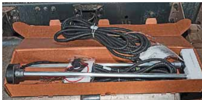
В каждый из двух баков седельного тягача установили свой датчик фиксации уровня топлива
