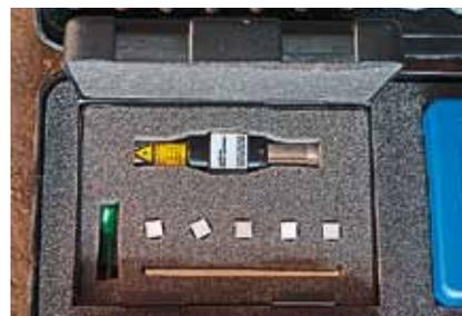
Прибор для проверки соосности приводных шкивов двигателя
