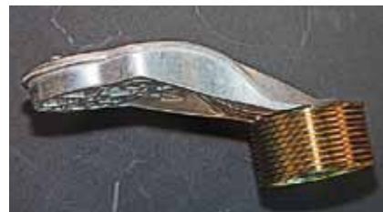
Шкив обводного ролика должен иметь 100% совместимость с ремнем
