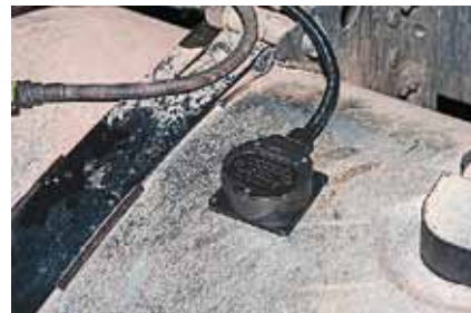
Посаженный на бак датчик никому не мешает
