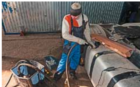
Для изменения уровня топлива в баке применили насос с точным счетчиком
