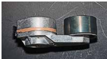
Большое значение имеет чистота обработки поверхности ролика
