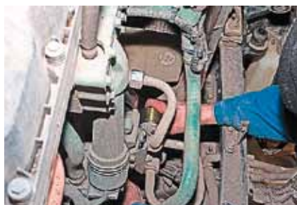
Ролики идеально встали на свои монтажные места на моторе
