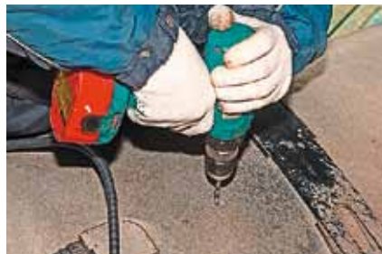
Топливный бак под датчик засверливался сначала тонким сверлом...
