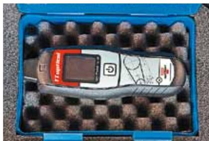
Прибор для контроля за натяжением приводного ремня
