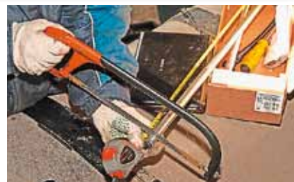
Каждый из датчиков был укорочен на строго определенную длину
