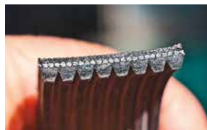
Приводной ремень имеет строго определенную форму зуба
