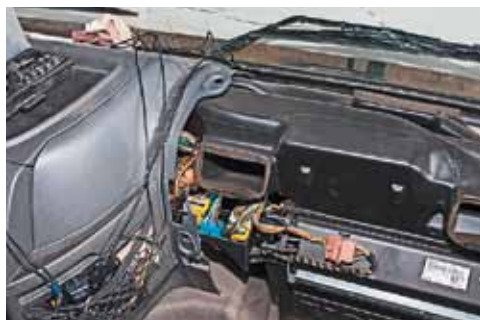
Для установки элементов системы в кабине пришлось снять панель
