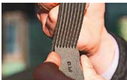
Прикладываем шаблон и оцениваем износ поверхности визуально
