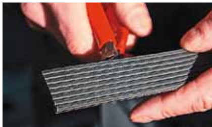
Одним из неоспоримых свойств материала ремней является его способность восстанавливать свою геометрию после снятия деформирующей нагрузки
