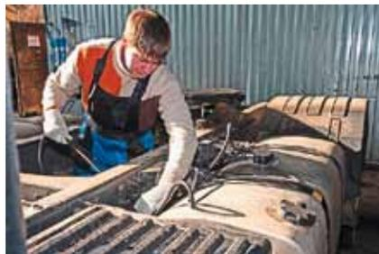
Дополнительная электропроводка прокладывалась в гофра
