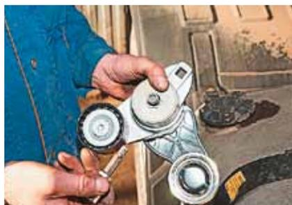
Два ролика при установке потребовали предварительной подсорбки
