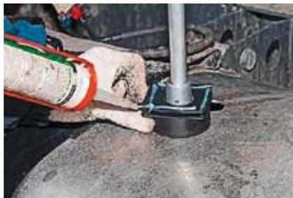
**Посадку датчиков обеспечил специальный герметик**
