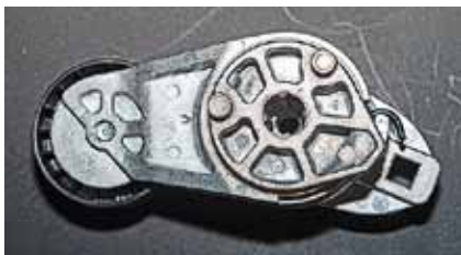
Два ролика из трех имеют механизм автоматического натяжения
