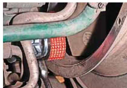
Ремень установлен – осталось привести в действие автоматы натяжения
