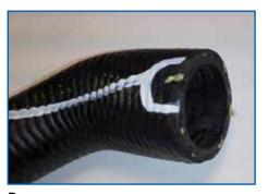
**Damage** Crack in edge area
