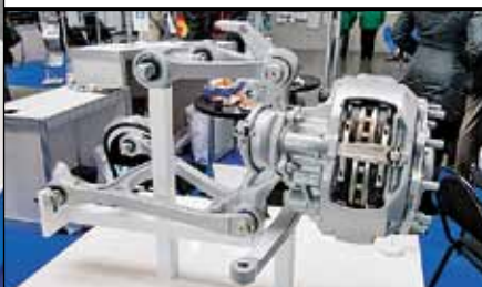
Угол поворота колес – 56 градусов для внутренних и 46 для внешних
