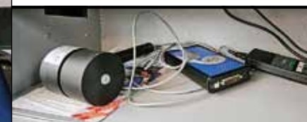
Прибор для измерения усилия закрывания дверей автобусов
