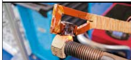
Системы индукционного нагрева помогут открутить «закисший» крепеж
