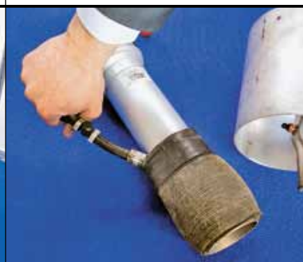
Манжета обеспечит герметичность стыка вытяжки и выхлопной трубы
