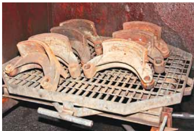
Перед ремонтом «башмаки» в обязательном порядке тщательно отмывают и дефектуют по износу
