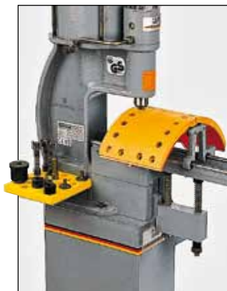
Наклейка фрикционов к «башмакам» должна производиться по определенной схеме. Ее указывает производитель ремкомплекта
