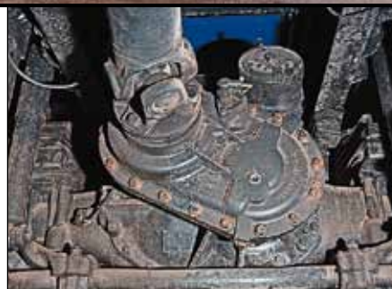
Средний мост на самосвалах колесной формулой 6x4 – проходной
