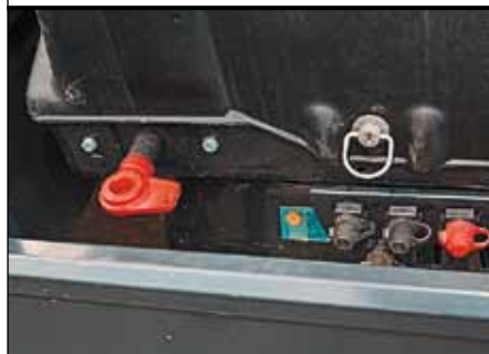
Выключатель массы сэкономит заряд батареи и машину от пожара
