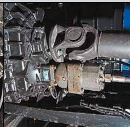
Отбор мощности на гидронасос – с заднего торца коробки передач
