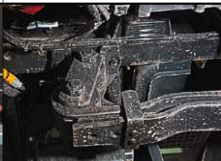
Шарниры серег рессор не требуют смазки – там сайлентблоки
