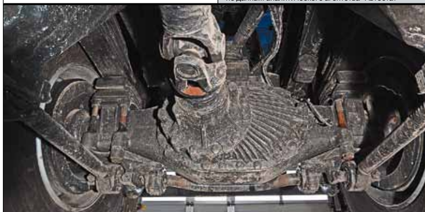
Балки ведущих мостов, как и положено, литые. Благодаря ступичным редукторам главные передачи компакты, а значит, увеличен дорожный просвет
