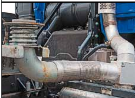
Зимой поток выхлопных газов переключают на подогрев кузова
