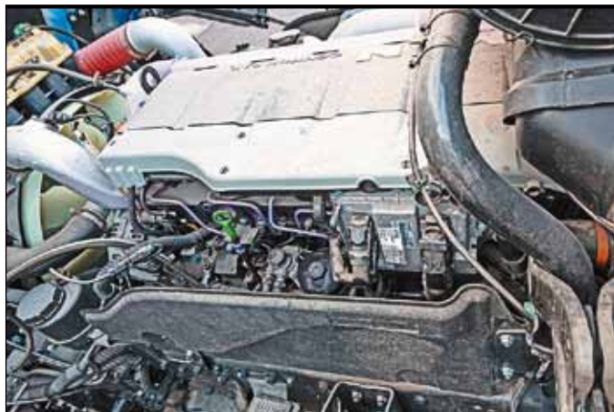
На двигателях MAN традиционно применяют топливную аппаратуру Common Rail. Заявленный ресурс – 1,5 млн км
