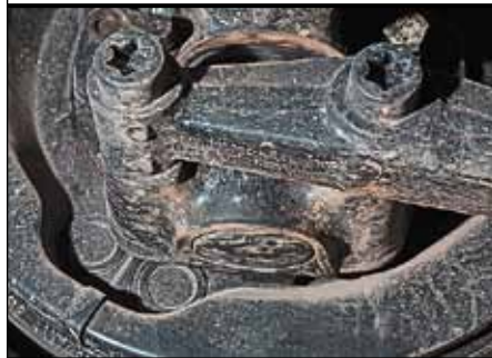
После большого пробега могут потребовать ремонта шкворновые узлы
