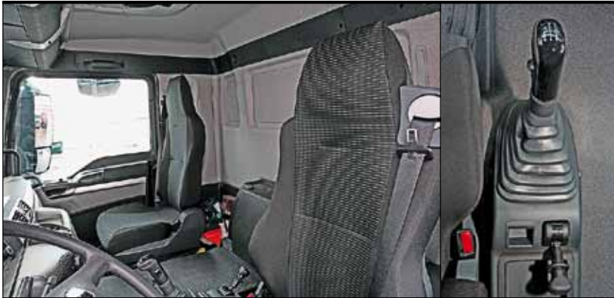
Дневная кабина тесновата, но для самосвала сойдет. Пол над мотором удобен, как столик. Кран стояночного тормоза под рукой – за рычагом КП
