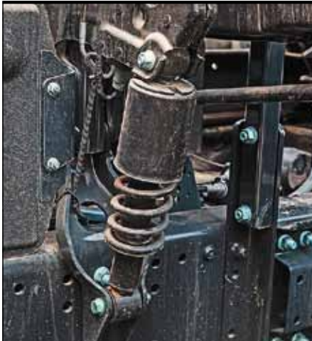
Подвеска кабины в задних точках – на пружинных амортизаторах
