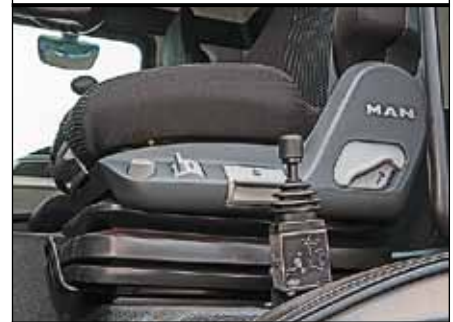
Кран включения отбора мощности на гидронасос – слева от сиденья
