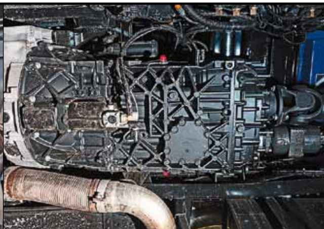
В руках умелого и бережливого водителя 16-ступенчатая коробка передач от фирмы ZF весьма долговечна
