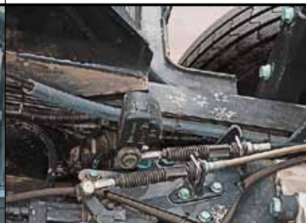
Признак износа шарниров наконечников тросов – люфт на рычаге КП
