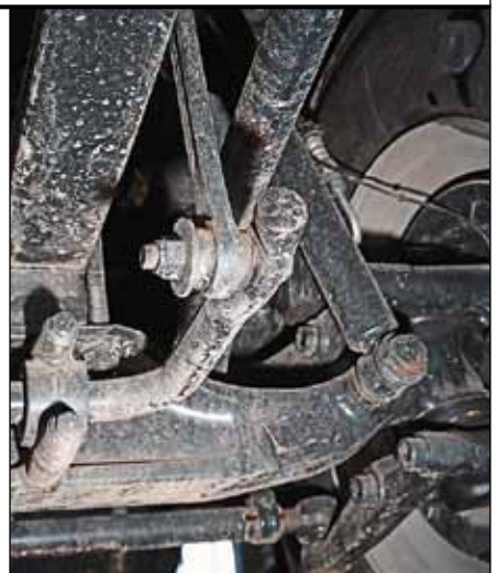
Заменить резиновые втулки стабилизатора – дело нескольких минут
