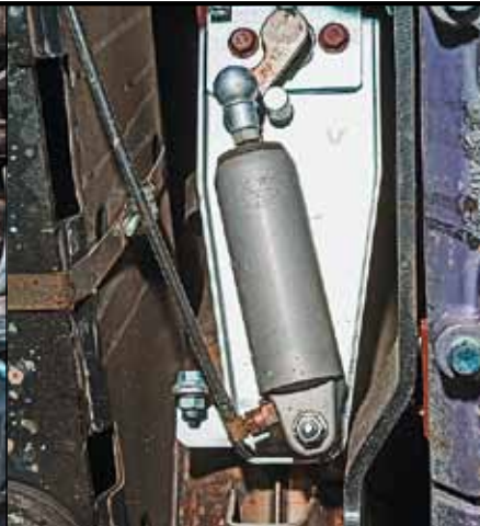
Заслонку горного тормоза поворачивает компактный пневмоцилиндр
