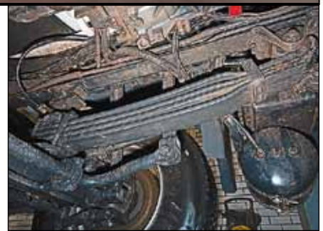
Подвеска второй рулевой оси шасси 8x4 – на трехлистных рессорах
