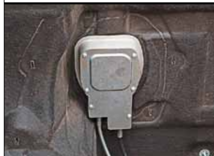
Привод управления коробкой передач – двумя гибкими тросами
