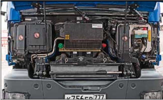
Почти все заправочные горловины выведены под откидную облицовку. Подвеска кабины – на сайлентблоках
