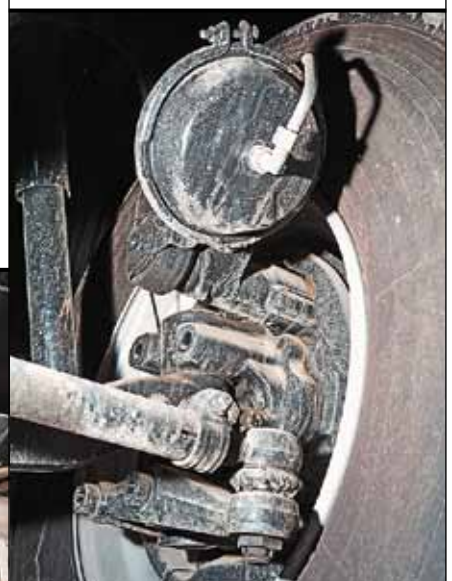
На самосвальных шасси российской сборки все тормоза – барабанные
