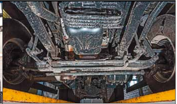
Балка переднего моста – без «ушей», что пошло на пользу проходимости самосвала на пересеченной местности
