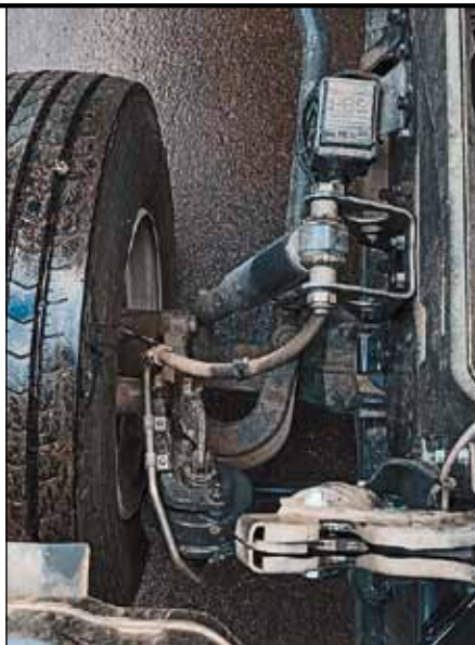
Блокировки колеса при торможении не будет – за этим следит блок EBS
