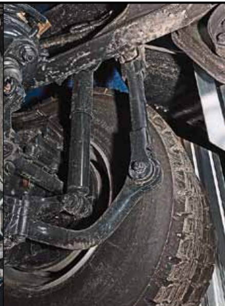
В подвесках ведущих мостов тоже предусмотрены стабилизаторы
