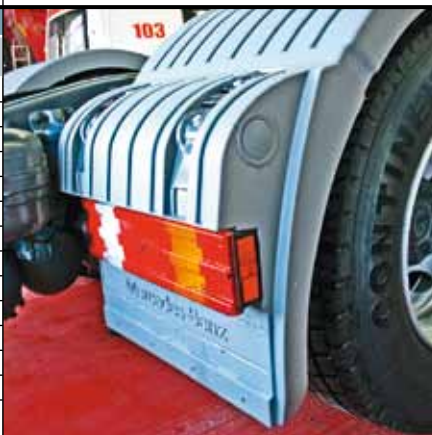
Крылья задних колес не рассчитаны на сильную тряску: ломаются
