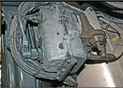
Насос SCR идет под замену при замерзании разбавленного реагента
