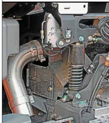
Подвеска кабины простая и надежная: сзади пружинные амортизаторы, спереди – сайлентблоки
