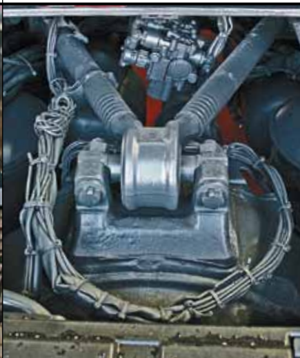
Шарнир V-образной тяги – как на витрине. Заменить проще простого
