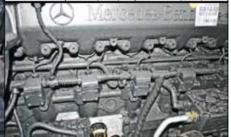
Моторы для России комплектуют топливной системой с PLD-секциями
