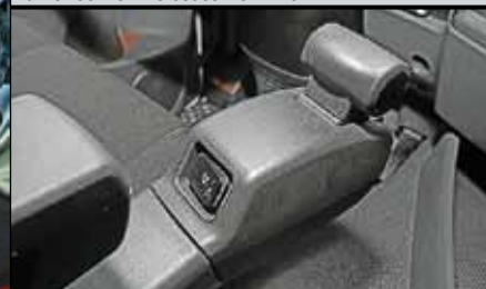
Для управления полуавтоматической КП здесь применен джойстик
