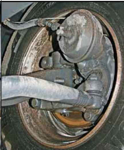
...а разбитый рулевой шарнир — уже дороже, и только вместе с тягой
