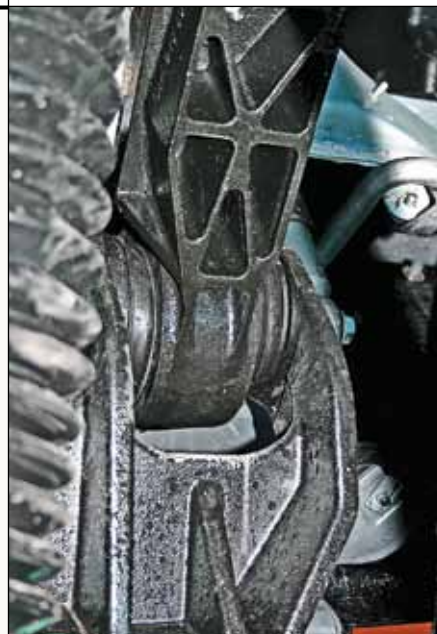
Подвеска кабины простая и надежная: сзади пружинные амортизаторы, спереди – сайлентблоки
