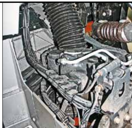
Рулевой карданный вал закрыт от пыли гофрированным чехлом
