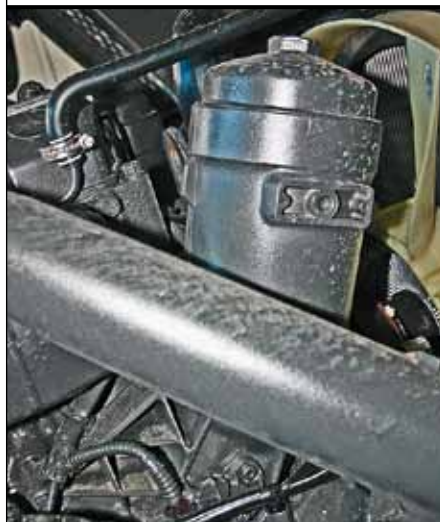
Моторное масло фильтрует бумажный картридж в несъемном корпусе
