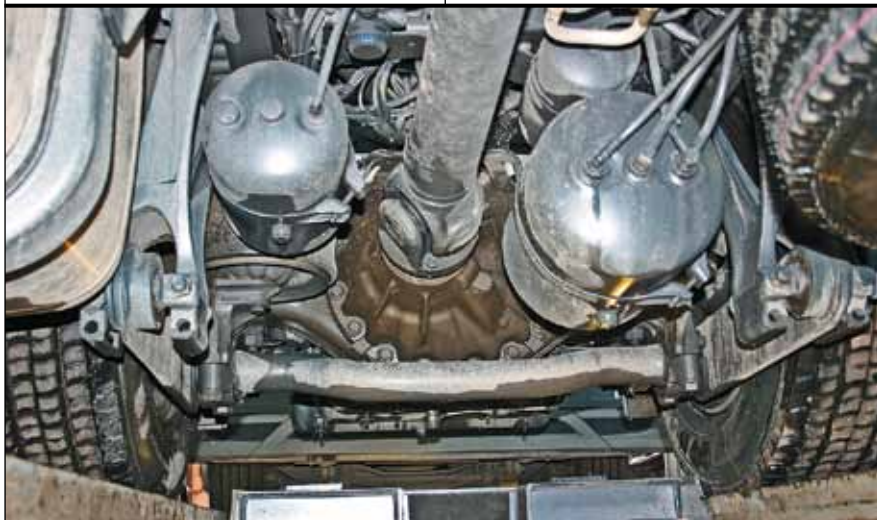
Пустое пространство между лонжеронами рамы и карданным валом эффективно использовано для размещения ресиверов пневматической системы
