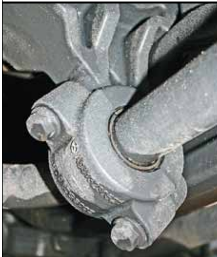
Заменить изношенную втулку стабилизатора просто и недорого...
