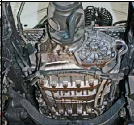
Чисто механическую КП на Ахор ставят, но, увы, только 9-ступенчатую
