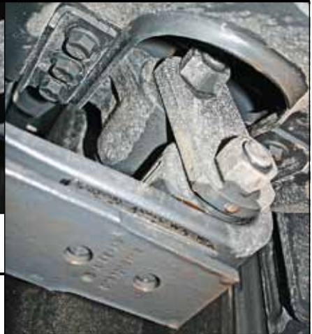
Шарниры серег рессор необслуживаемые: в них сайлентблоки
