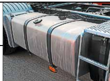
650-литровый бак из алюминия закреплен на правом лонжероне рамы
