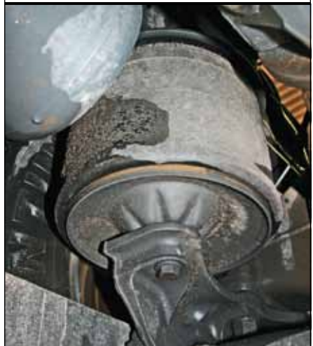
В задней подвеске по одному пневмобаллону с каждой стороны
