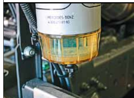
Польза топливного сепаратора очевидна – на дне скопилась вода
