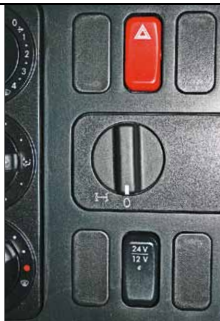
Блокировка межосевого дифференциала пригодится на льду или снегу
