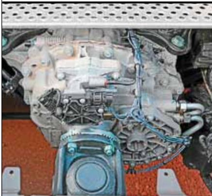
Узел управления автоматической КП иногда разбивают краем прицепа
