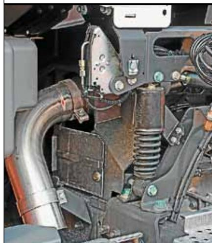
**Подвеска кабины простая и надежная: сзади пружинные амортизаторы, спереди – сайлентблоки**
