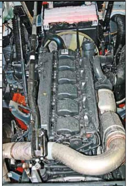
**9-ступенчатая механическая КП (сверху) управляется телескопической тягой. Если тяги нет, значит, на машине «полуавтомат» с джойстиком**
