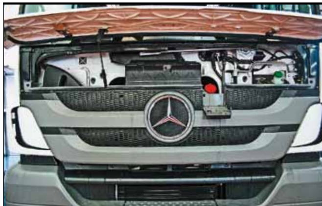
Особенность кабины бюджетника – узкая облицовка передней панели. Решетка радиатора не откидывается
