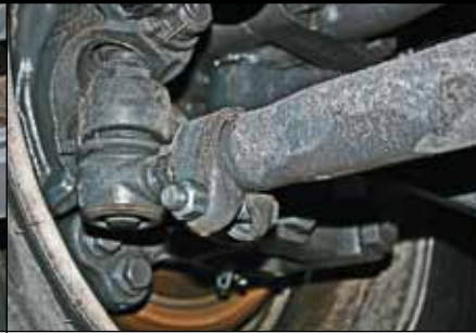
Если залюфтит только левый шарнир, то его можно заменить без тяги
