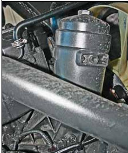
Моторное масло фильтрует бумажный картридж в несъемном корпусе
