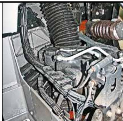
**Рулевой карданный вал закрыт от пыли гофрированным чехлом**
