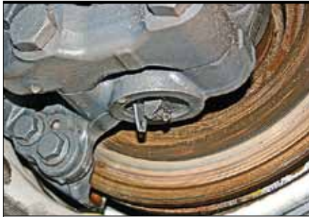
Пресс-масленки в шкворневых узлах применяет даже Mercedes-Benz
