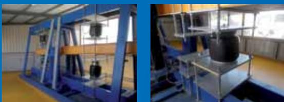
Die Luftfeder wird in der Zielfahrzeughöhe installiert und mit 5 bar Luftdruck gefüllt. Der Ermüdungstest erfolgt unter der Eigenfrequenz von 3,3 Hz bei einem Zyklusabstand von  $\pm 50$  mm. Vorgabe der Erstausrüstung ist, dass die Luftfeder mindestens 3.000.000 Zyklen ohne Schäden an der Außenstruktur oder den Montageteilen erreicht. Dieser Ermüdungstest wird zu Vergleichszwecken durchgeführt (Markenhersteller vs. EUROPART).
