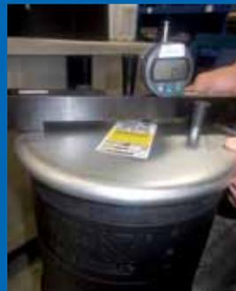
Alle Metallkopfplatten werden nach dem Bördelprozess zu 100 % auf Konkavität und Konvexität getestet. Die Luftfeder darf keine Konkavität oder Konvexität vorweisen, da ansonsten die Stehbolzen nicht am Fahrgestell montiert werden können.
