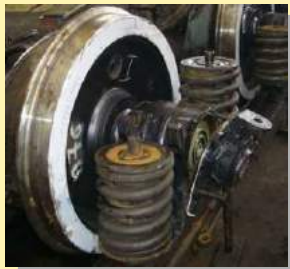
На фотографии представлена существующая технология закладывания смазки «Буксол» в подшипник буксового узла.
