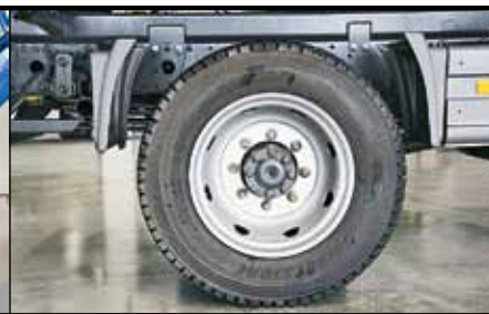
Крепление колес – без футорок с центровкой на пояске ступицы
