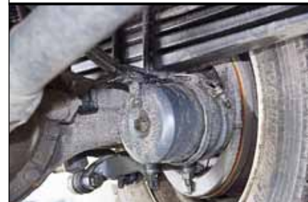
На задних колесах – дисковые тормоза с энергоаккумуляторами
