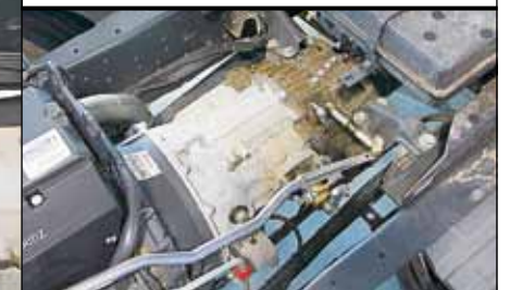
Механизм переключения коробки передач приводится одной тягой...
