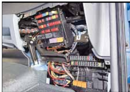
Блок реле и предохранителей – под крышкой панели приборов справа
