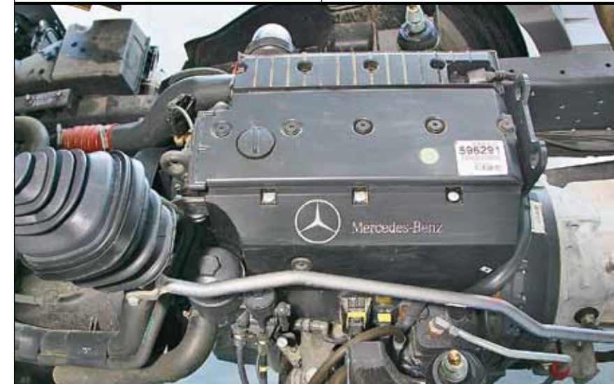
Четырехцилиндровый 12-клапанный мотор весьма компактен. Система питания – с PLD-секциями: индивидуальные насосы в блоке, а форсунки в головке
