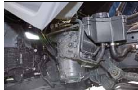
Бачок для жидкости ГУРа закреплен рядом с рулевым механизмом
