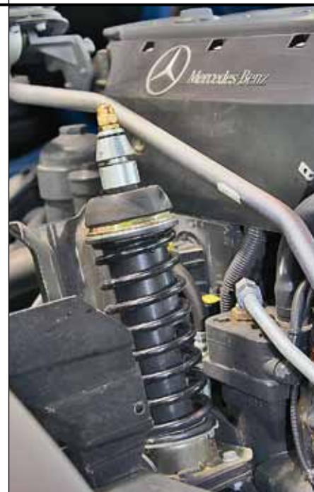
Подвеска кабины – на стойках с гидравлическими амортизаторами
