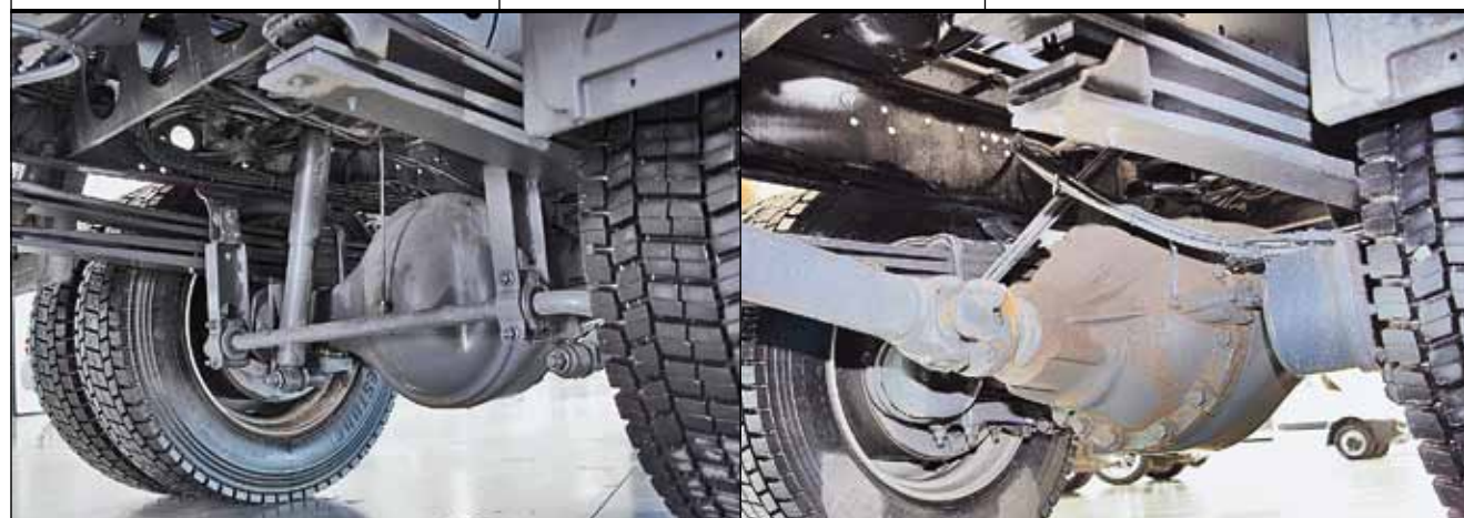
Штанга стабилизатора поперечной устойчивости подвешена на длинных кронштейнах. Заменить подушки нетрудно
