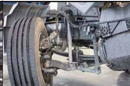
В параболических рессорах передней подвески всего по два листа
