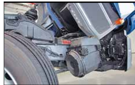
Воздушный фильтр размещен в арке переднего правого колеса
