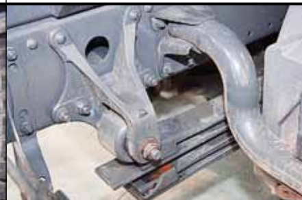
Два нижних листа задних рессор выполняют роль подрессорников
