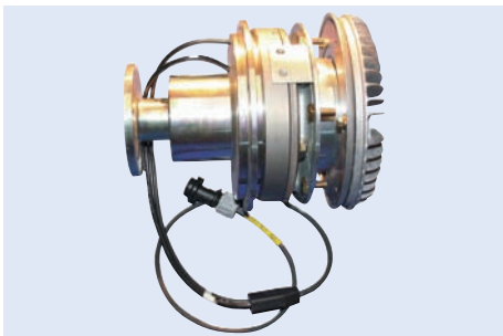
Radiator fan coupling
