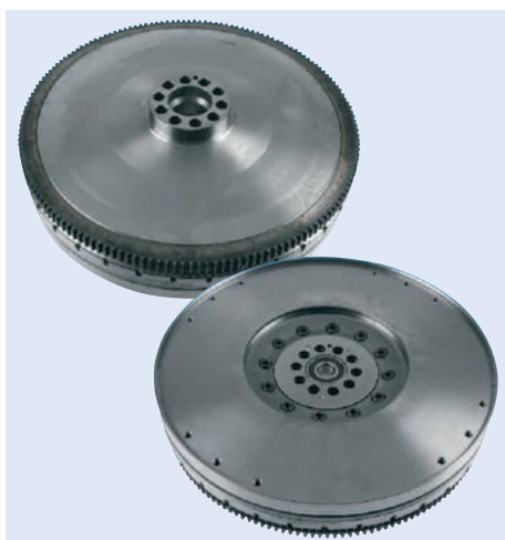
SACHS Dual mass flywheel Parameter 430Z Ø 430 mm
