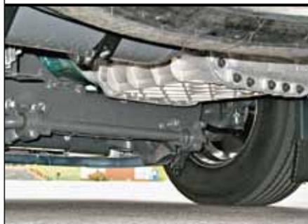
**В версии с независимой подвеской торсион стабилизатора – сзади балки**
