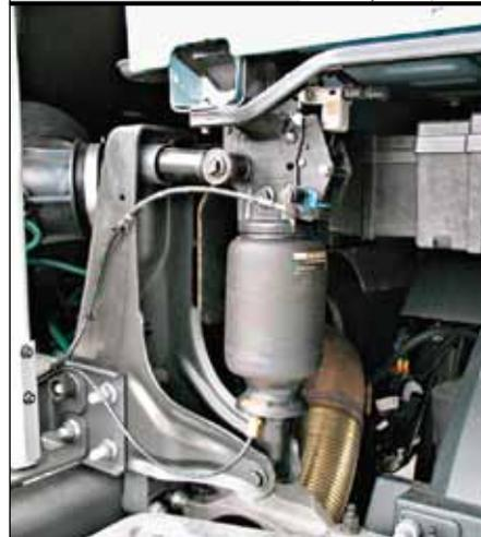
**Подвеска кабины тягачей – четырехточечная, пневматическая**
