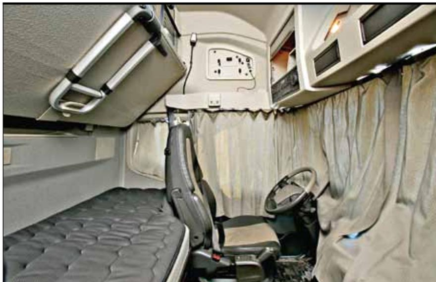
На нижней полке шириной 82 см вольготно разляжется водитель любой комплектации. Над дверным проемом – подготовка для установки телевизора
