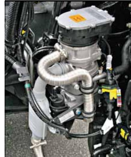
Жидкостный автономный отопитель входит в базовое оснащение
