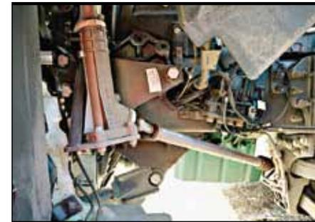
Для передачи усилия от руля на зубчатую рейку нужен угловой редуктор
