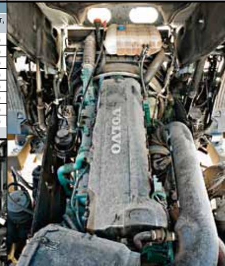
Фирменная особенность двигателей Volvo – распредвал в головке блока
