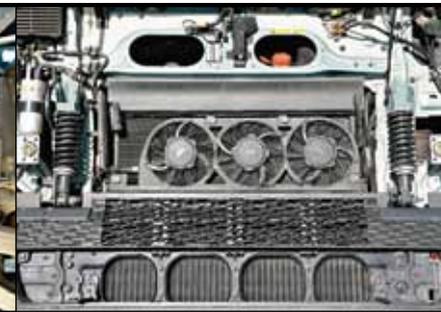
Испаритель кондиционера кабины оборудован тремя вентиляторами
