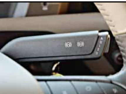
У рычажка моторного тормоза – он под рулем справа – пять положений
