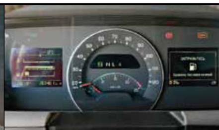
Шкала тахометра встроена в спидометр. Справа – окно предупреждений
