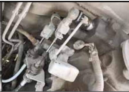
Тросовый привод кулисы КП позволил разместить рычаг на торпедо
