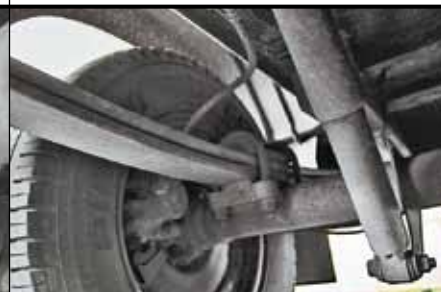
...зато задняя подвеска на малолистовых рессорах вполне надежна
