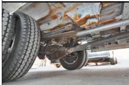
Первой выходит из строя задняя крестовина карданной передачи
