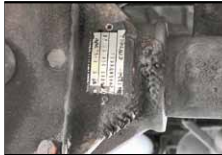
В табличке на картере моста указано количество зубьев шестерен
