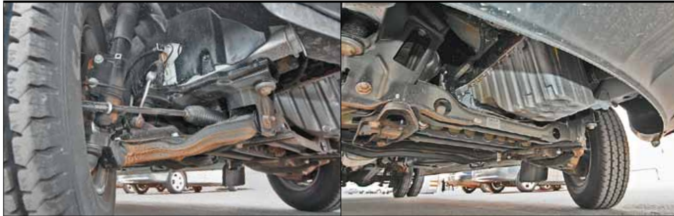
Штампованные рычаги, амортизационные стойки и реечный рулевой механизм – типично «легковая» схема...
