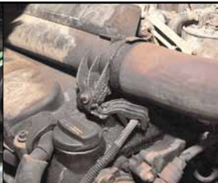
На неухоженных моторах с большими пробегами появляются потеки масла
