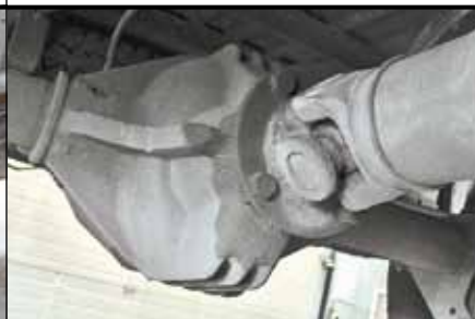
Вибрация вызывает люфт в подшипниках хвостовика и течь сальника...
