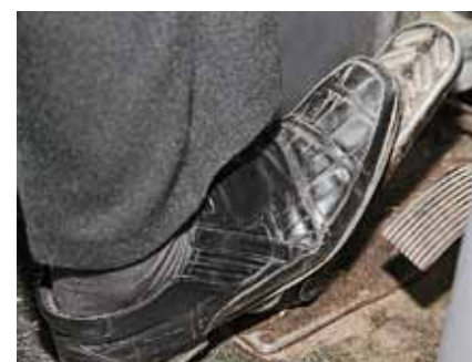
Зазор между колодками и барабанами выбирается после пяти-десяти плавных нажатий на педаль тормоза
