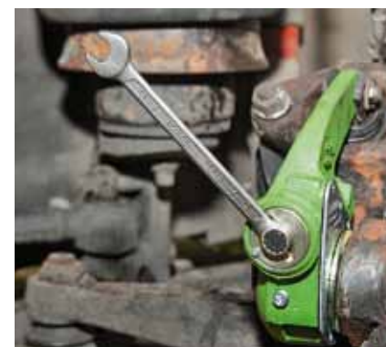
После установки трещоток необходимо развести колодки всех механизмов
