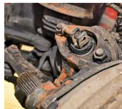
При установке трещоток штоки тормозных камер должны быть втянуты
