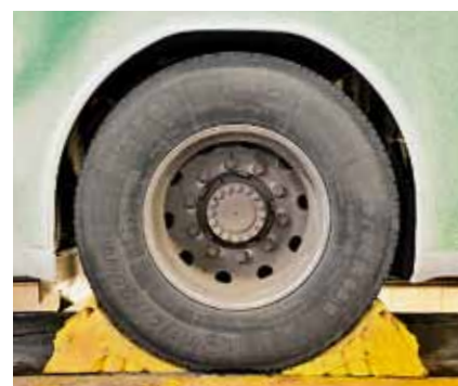
Поскольку работы проводятся на расторможенном автомобиле, в обязательном порядке ставим под колеса башмаки
