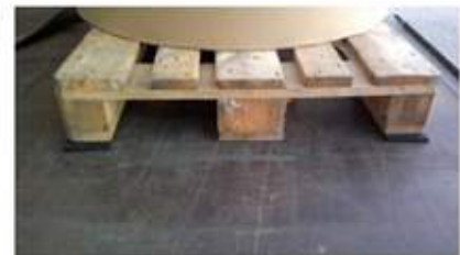
Bild 1: Palette mit Ladung auf 6 Stück RhM Pads PKD 720 – Kufen längs zur Zugrichtung
